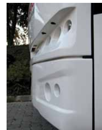
Фрагмент передней маски. Фары дальнего и ближнего света Vi-Xenon с индивидуальными омывателями
