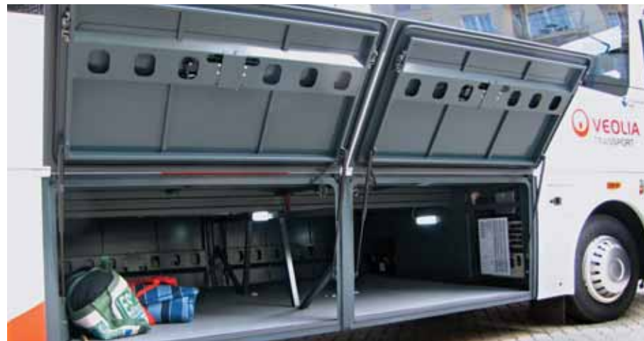
▲ Фрагмент передней подвески ▲ Багажный отсек. К сожалению (для российских эксплуатационников), он ровно пять кубометров...
