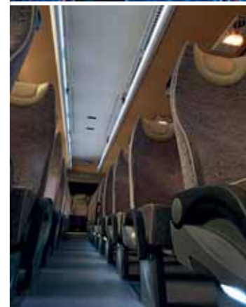
Салоны с сиденьями «эконом» и «топ». Во втором случае включено освещение: лампы дневного света встроены в кромки багажных полок и смотрятся как две светящиеся линии. Однако во время движения водитель может между ними включить синий пунктир ночной подсветки: вообще фантастический эффект!
