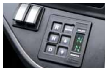
Рабочее место водителя. На самом видном месте самый дешевый из возможных кнопочный пульт управления АКП
